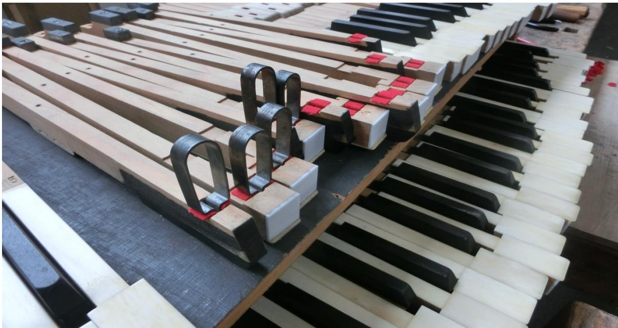
Neugarnierung sämtlicher Tasten
