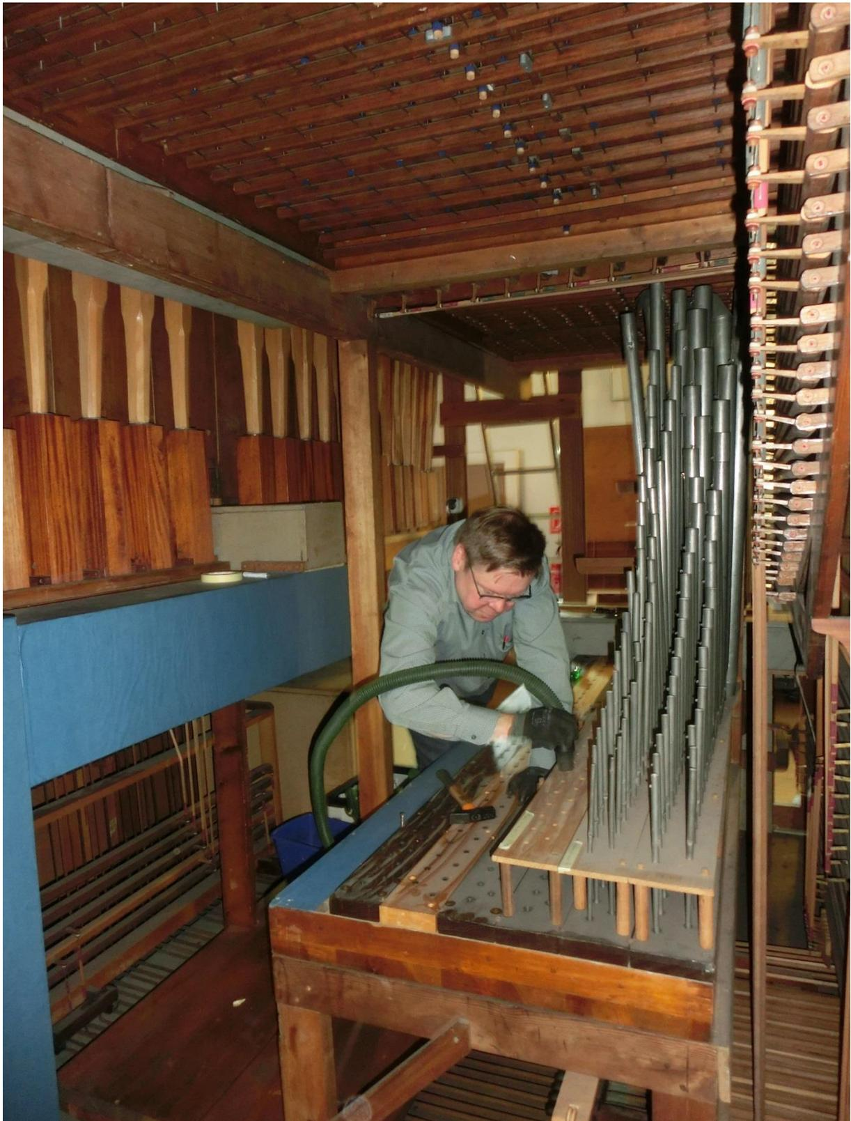
Ausbau des Pfeifenbestandes aus dem Unterwerk der Meyer-Orgel und Vorreinigung
