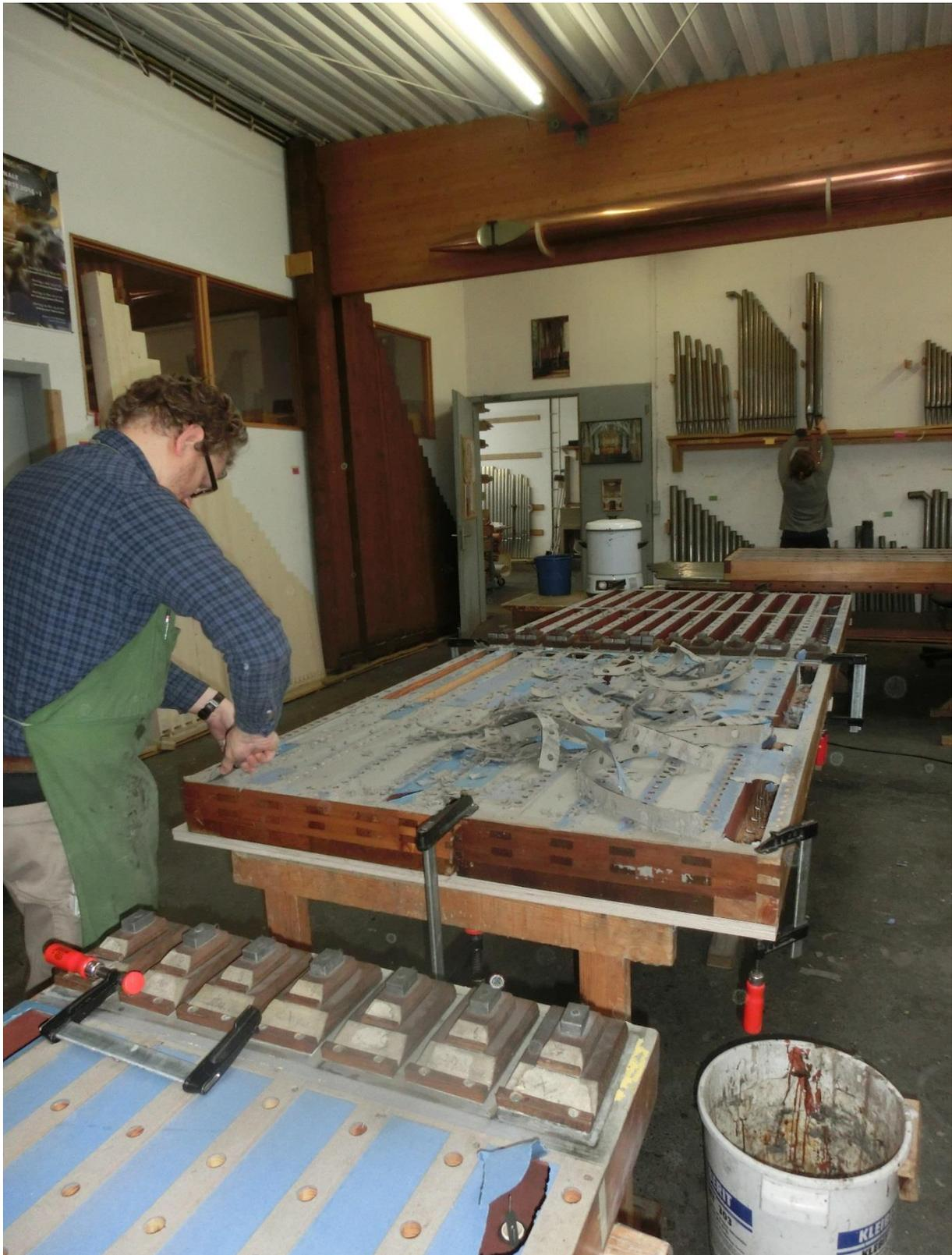
Öffnen der Registerkzellen und Dokumentation des Istzustandes der Windladen in der Orgelbauwerkstatt
