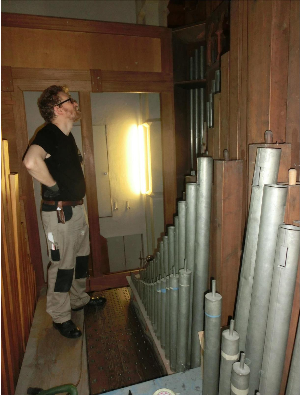
Ausbau des Pfeifenbestandes aus dem Hauptwerk der Orgel
